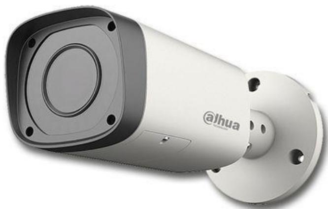
IR camera HDCVI da esterno/interno IP66 con sensore progressivo 1/3" CMOS da 1.4Mp, risoluzione 720p con 50Fps, ICR meccanico, ottica varifocale 2.7~12mm motorizzata, luminosità 0.002Lux (0 con LED ON), led IR portata fino a 30mt, 2-3D, uscita video HD-CVI o PAL, OSD su cavo coassiale, alimentazione 12Vdc <600mA, in dotazione staffa di fissaggio
