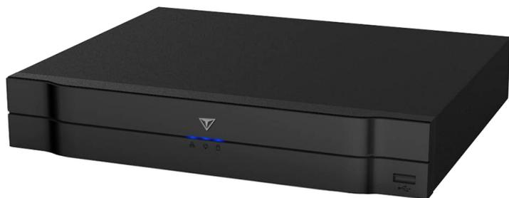
NVR/DVR 4 canali HD-CVI/CVBS/IP a 1.080p + 2ch IP fino a 5Mp, rapporto risoluzione/frame e bit rate variabile (1Kbps~6.144Mbps) per singolo canale, 2 uscite video principali (1 VGA + 1 HDMI), 1 ingresso e 1 uscita audio bidirezionale, predisposto per montaggio di 1 disco SATA (fino a 6TB), 2 porte USB (mouse, backup), 1 porta RS485, 1 LAN 10/100Mbps, alimentazione esterna a 12Vdc <10W senza Hard Disk
