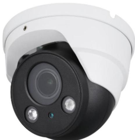
Eyeball HDCVI da interno/esterno IP67, sensore CMOS progressivo 1/3', risoluzione 4.1 MP a 25/30fps, ICR, ottica motorizzata 2.7~13.5 mm f1.3, luminosità 0.01 Lux f1.3 (0 con IR On), portata IR fino a 60 m, 2/3D, WDR 120 dB, out HDCVI/CVBS, audio, OSD, alimentazione 12 Vdc <8.4 W
