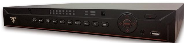
NVR 32 canali IP fino a 12Mp, rapporto risoluzione/frame e bit rate variabile (16Kbps~20Mbps) per singolo canale, massima banda 320Mbps (REC 320Mbps, Tx 128Mbps), 4 ingressi e 2 uscite di allarme, 2 uscite video principali (1 VGA + 1 HDMI), 1 ingresso e 1 uscita audio, predisposto per montaggio di 2 dischi SATA (fino a 6TB cad.), 2 porte USB (mouse, backup), 1 porta RS232, 1 LAN 10/100/1.000Mbps, alimentazione interna a 12Vdc <16.7W senza Hard Disk
