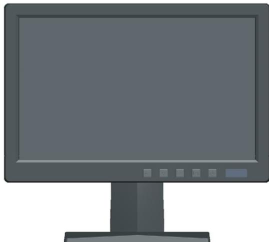
Monitor LED da 10" formato 16:9 in cabinet plastico, risoluzione massima 1.280x800, contrasto 800:1, luminosità 300cd/m2, 3 ingressi video (1 BNC + 1 VGA + 1 HDMI), 1 uscita video BNC, 1 ingresso audio integrato, speaker integrati, alimentazione 12Vdc <15W, staffa da tavolo inclusa
