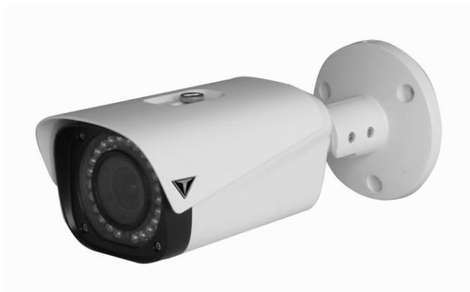
IR camera HDCVI da esterno/interno IP67, sensore progressivo 1/2.7" CMOS da 2Mp, risoluzione 1.080p con 25Fps o 720p con 50Fps, ICR meccanico, ottica motorizzata 2.7~12mm, luminosità 0.03Lux  $f$ 1.4 (0 con IR led ON), led IR portata fino a 60mt, 2 uscite video (1 HDCVI + 1 CVBS), 2-3D, WDR (120db), OSD su coassiale, alimentazione 12Vdc <8.2W
