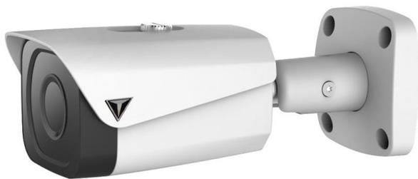
IR camera IP H265 da esterno/interno IP67 con analisi video base, sensore CMOS progressivo 1/2.8" STARVIS, risoluzione 2Mp con 50Fps, ICR auto, ottica fissa 3.6mm, luminosità 0.007Lux  $f$ 1.6 (0 con Led ON), portata led IR fino a 40mt, porta LAN 10/100Mbps, 1 slot MicroSD-Card per brevi backup, privacy mask 4 aree, 3D, WDR (120dB), alimentazione 12Vdc o ePoE <6W
