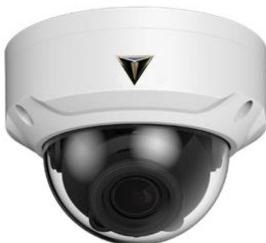
IR dome HDCVI da esterno/interno IP67 antivandalo IK10, sensore progressivo 1/3" CMOS da 4Mp, risoluzione 2K con 25Fps, ICR meccanico, ottica 2.7~13.5mm *f*1.4 motorizzata, luminosità 0.01Lux *f*1.3 (0 con LED ON), led IR portata fino a 30mt, 2-3D, WDR (120db), 1 uscita video (1 HD-CVI o 1 CVBS), OSD su coassiale, alimentazione 12Vdc <7.5W
